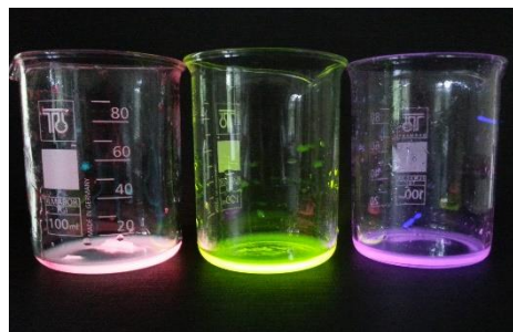
Slika 7: Iz leve: 1. časa: dodatek destilnani vode, 2. časa: dodatek vodne raztopine natrijevega hidroksida (0,1M), 3. časa: dodatek vodne raztopine klorovodikove kisline.
